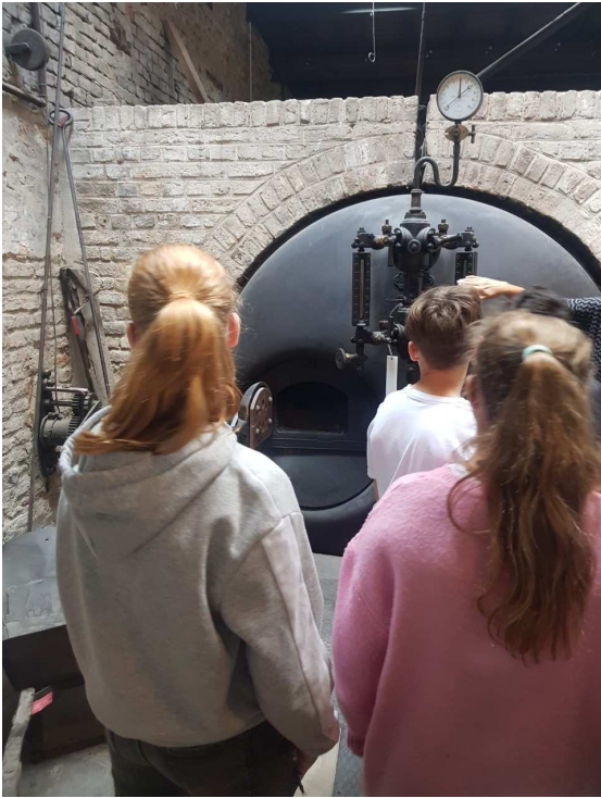
Mit diesem Ofen wurden alle Maschinen der Tuchfabrik angetrieben.
